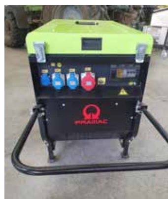
Universalgenerator mit sechs Kilovoltampere Leistung
