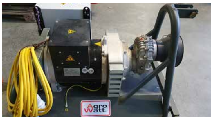
Zapfwellengeneratoren sind meistens die erste Wahl zur Herstellung einer Notstromversorgung am landwirtschaftlichen Hof.
