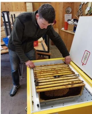
Abbildung 1: Einhängen von Brutrahmen in den Varroa-Controller
