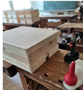
Abbildung 2&3: Klimadeckel bei der Produktion und Befüllung mit Hobelspänen
