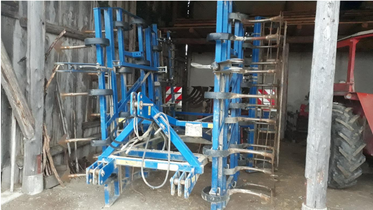
Leichtgrubber mit Gänsefußscharen zur ganzflächigen Saatbettbereitung
