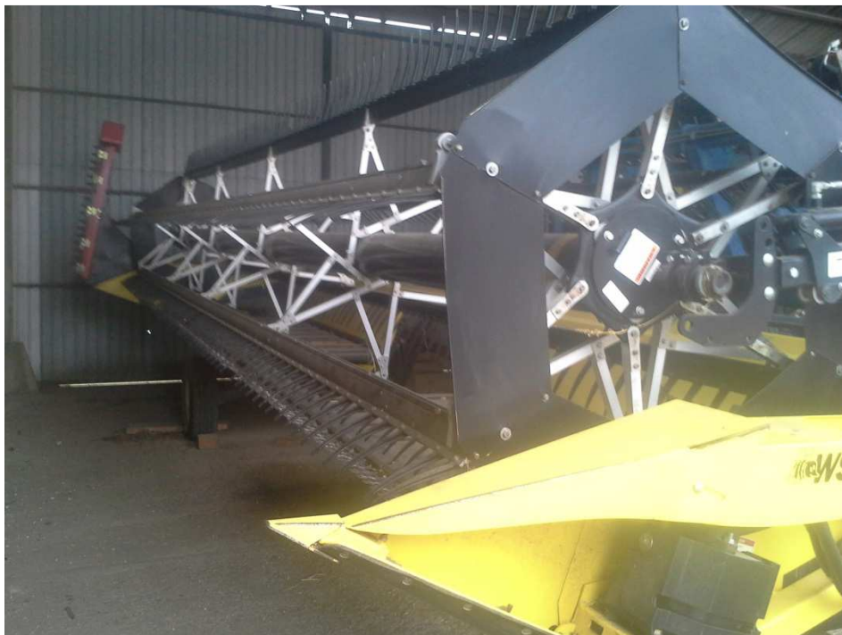
Abb.5: 7,5m-Schwadmäher für den Traktoranbau mit Langfahreinrichtung
